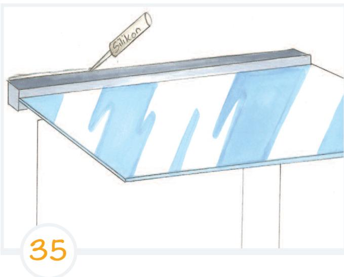
*Wir empfehlen Ihnen eine Silikonierung an der Profilerkante, damit kein Wasser hinter dem Profil herlaufen kann. Besonders bei stark strukturierten Fassaden (z.B. Klinker) kann es sonst zu Wassereintritt kommen.*
